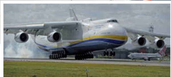
Verladung in einen Riesenvogel: Die russische Antonov An-225 hat eine Flügelspannweite von 88 Metern, ist 84 Meter lang und 18 Meter hoch. Sie kann 250 Tonnen Fracht transportieren.
