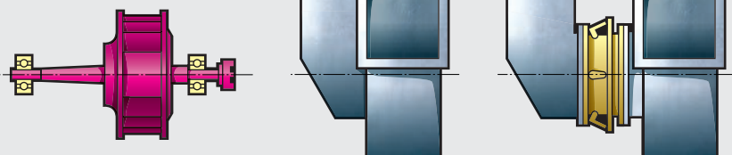
Рабочее колесо с двухсторонней подшипниковой опорой и соответствующей конфигурацией всасывания
