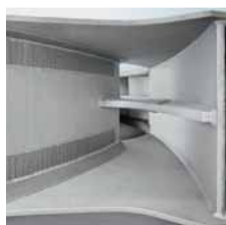
Комбинация различных защитных материалов на лопасти крыльчатки
