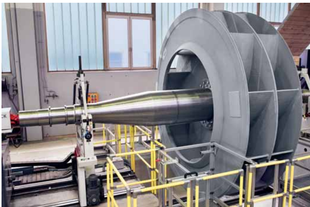
Балансировка двухпоточного ротора
