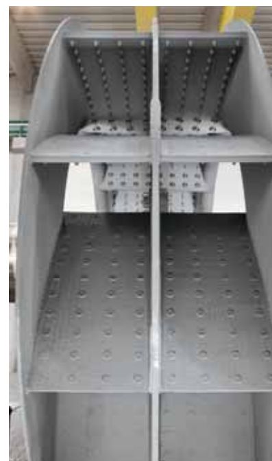
Сварные и болтовые соединения защитных пластин на крыльчатке
