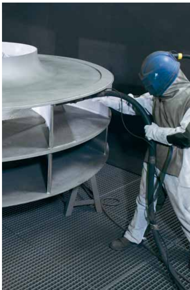
Очистка двухпоточной крыльчатки для анализа повреждений
