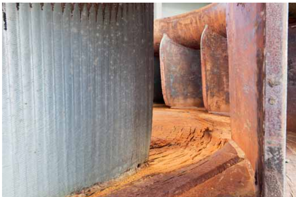
Крыльчатка с износом центрального диска
