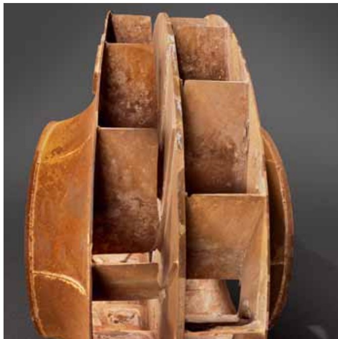
Крыльчатка, поврежденная в результате отсутствия защиты от износа
