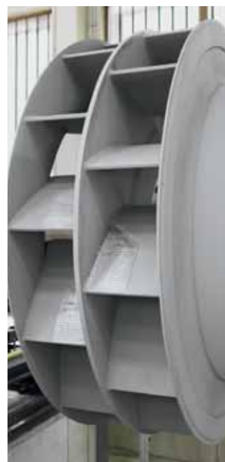
Целенаправленная защита от износа на лопастях крыльчатки
